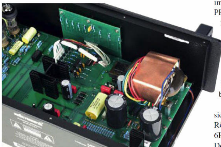
Trafo made in USA: Ein rechteckiger Eisenkern mit rundem Querschnitt ist streufeldärmer als eckige Pendants. Das Kupferband vermindert die Abstrahlung zusätzlich.
