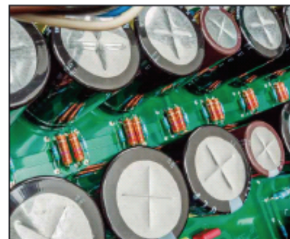
Massen von Siebkapazität sind ein Mittel, um saubere Betriebsspannungen zu erhalten
