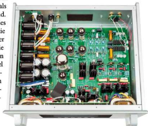
An der linken Gehäusewand gibt's eine dicke Elko-Batterie, die bei den Reference-Vorstufen seit dem „SE“-Upgrade Standard ist
