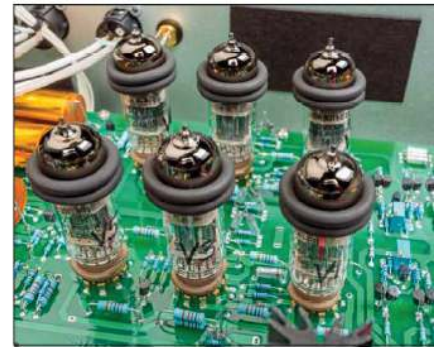
Sechs 6H30P bilden den Röhrenpart der Verstärkerabteilung
