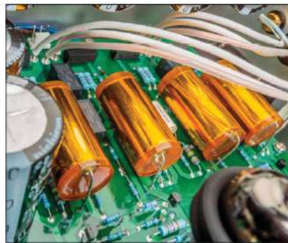
Die brauchen ewig, bis sie eingespielt sind: die sonderangefertigten Ausgangskoppelkondensatoren
