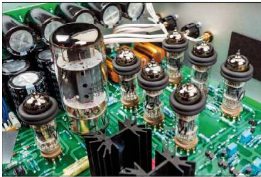
Die dicke 6550 regelt die Anodenversorgung der Signaltuben
