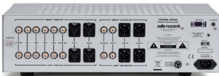
ALLES DRAN: Gehört die SP 20 selbstredend einer Fernbedienung, fügt sie sich via RS-232 in Home-Automation. Auch wenn AUDIO die Cinch-In und -Outs als gleichwertig empfand, empfiehlt es sich, wenn möglich, die symmetrischen Anschlüsse zu nutzen.
