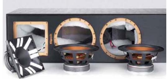
**KRAFTVOLLE ANTRIEBE:** Alle Treiber verfügen über wuchtige Magnetsysteme, die bei den Tiefmitteltönern ungewöhnlich große Auslenkungen zulassen. Der auffallend hohe Wirkungsgrad entsteht durch verlustarme Filter und Schwingsysteme in Kombination mit üppigen Membranflächen. Der Hochtöner profitiert von einem großflächigen Horn.
