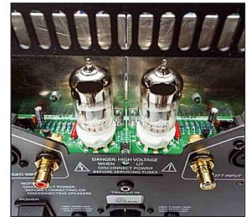
Hinter dem Abdeckgitter auf der Rückseite röhrt's: Zwei Doppeltrioden bilden die Eingangsstufe der PS-Audio-Endstufe
