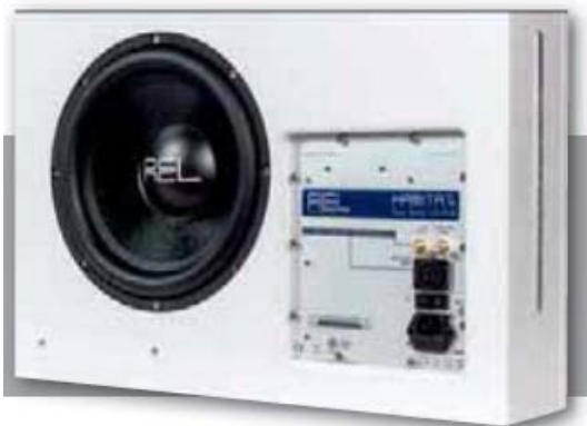
Der große Treiber ist eine Passivmembran, die physikalisch etwa einem Reflexrohr entspricht
