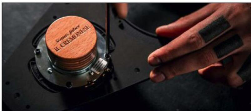
**HOLZKAMMER:** Der Hochtöner sitzt in einem eigenen Gehäuse aus Holz, das mit seiner labyrinthartigen Struktur innere Reflektionen unterbindet.
