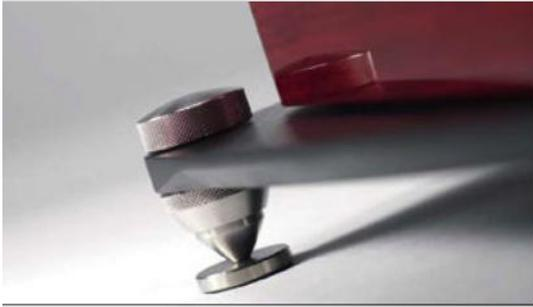
**AUF LEISEN SOHLEN:** Die Spikes mit „Zero Vibration Transmission“ aus einem koaxialen Verbund von Metall und Elastomer entkoppeln den Lautsprecher wirkungsvoll vom Untergrund.
