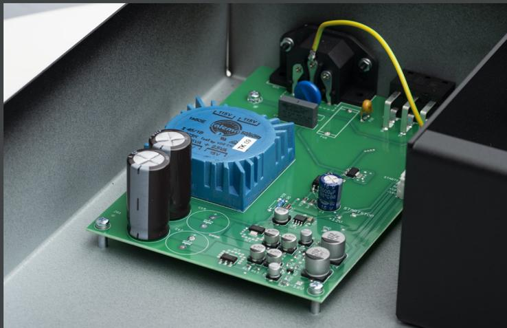
Spezielles Phono PSU-Design mit toroidalem Transformator mit niedriger Kernsättigung zur Minimierung elektromagnetischer Strahlung
