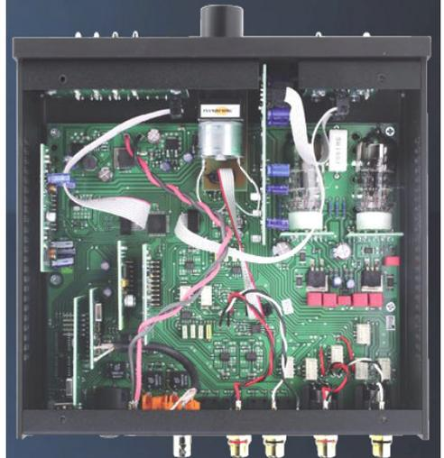
SMD-Bauweise und separate Schaltungsgruppen auf aufrecht verlöteten Sub-Leiterplatten ermöglichen der PRE Box RS trotz beengter Platzverhältnisse eine unglaubliche Funktionsvielfalt. So können in ihrer Ausgangsstufe sogar Röhren und Halbleiter in friedlicher Koexistenz leben.
