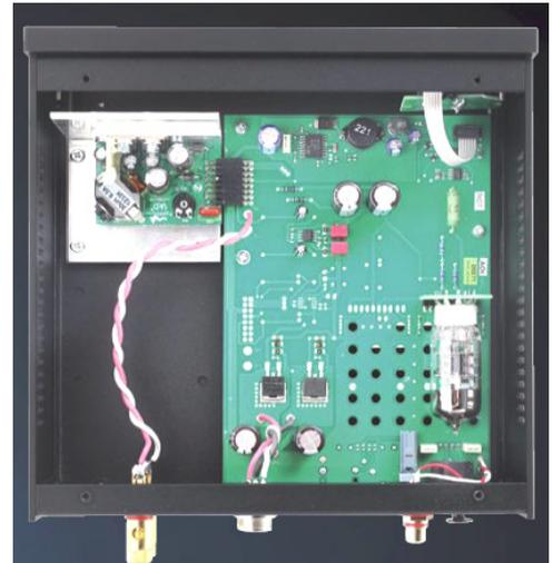
Die Nennleistung von über 150 Watt an 4-Ohm-Lautsprechern bei der AMP Box RS deutet auf Schaltverstärker-Betrieb hin. Stimmt: Für die Leistungsendstufe kommt ein Modul des niederländischen Spezialisten Hypex zum Einsatz (siehe Kasten, Seite 37). Es beansprucht weniger Raum als die mit Röhren bestückte Eingangsschaltung.
