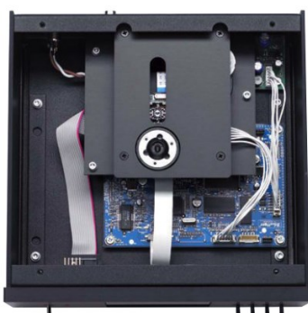
Weil das Laufwerk (links) neben üblichen Audio-CDs auch CDDAs oder CD-ROMs mit MP3- oder FLAC-Files (bis 24/96) abspielen kann, hat es eine eigene Hardware-Decoder-Plattform an Bord (Blue Tiger CD 100), die auch gleich für das (zuschaltbare) zwei- oder vierfache Daten-Upsampling zuständig ist. Der D/A-Wandler (rechts) erlaubt direktes Umschalten beim Hören zwischen Röhren- und Transistor-Ausgangsstufe.
