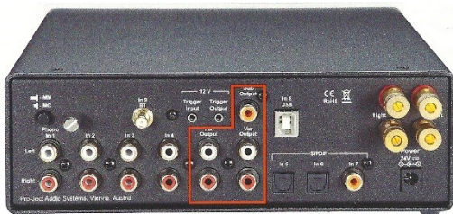
▲ Auf einer Grundfläche von rund 20 x 7 Zentimetern beherbergt der MaiA DS neun unterschiedliche Eingänge sowie drei alternative Line- und Vorverstärker-Ausgänge (Rahmen).
