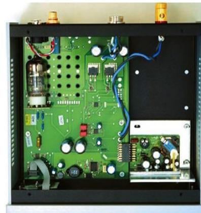
Pro-Ject packt eine ECC88 in die Röhren-Puffervorstufe. Danach geht der Signalweg strickt digital weiter – ein Zukauf von Hypex. Das Netzteil ist komplett ausgelagert.
