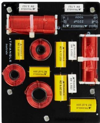
Australe EZ wird durch High-End-Prozesse optimiert. Die Frequenzweiche ist zweigeteilt, um elektromagnetische Beeinflussungen zu vermeiden. Ein Teil ist für die mittleren / hohen Frequenzen und das andere für die niedrigen Frequenzen bestimmt.
