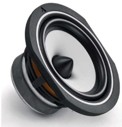
Der Tiefmitteltöner ist eine Hybridkonstruktion: Triangle setzt auf die leichte, aber dennoch steife Papiermembran aus den reinen Mitteltönern und kombiniert sie mit einer deutlich ausladenderen Gummisicke, die wesentlich mehr Hub erlaubt.
